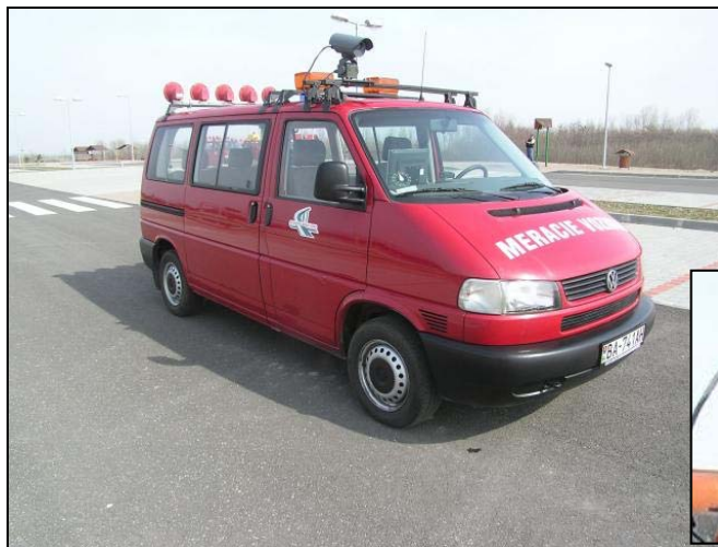
SKIDDOMETER – zariadenie na meranie protišmykových vlastností SKIDDOMETER – equipment for skid resistance measurements
