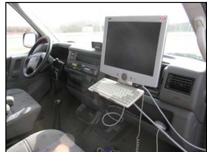
VIDEOVOZIDLO - zariadenie na rýchle vizuálne prehliadky vozoviek VIDEOCAR – equipment for quick visual inspection of pavement
